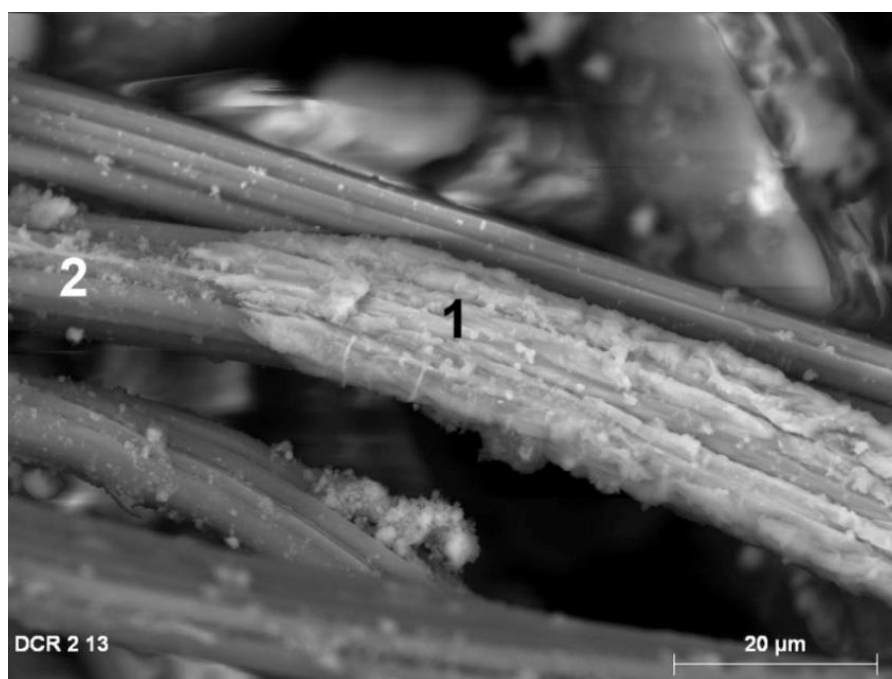
Figura 19. Dama del Cerro de los Santos. Presencia de yeso disuelto y recristalizado (1) sobre una fibra (2).
