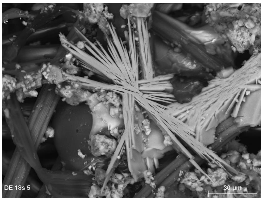
Figura 10. Dama de Elche. Imagen de microscopía electrónica de barrido del yeso recristalizado con textura fibroso-radiada.
